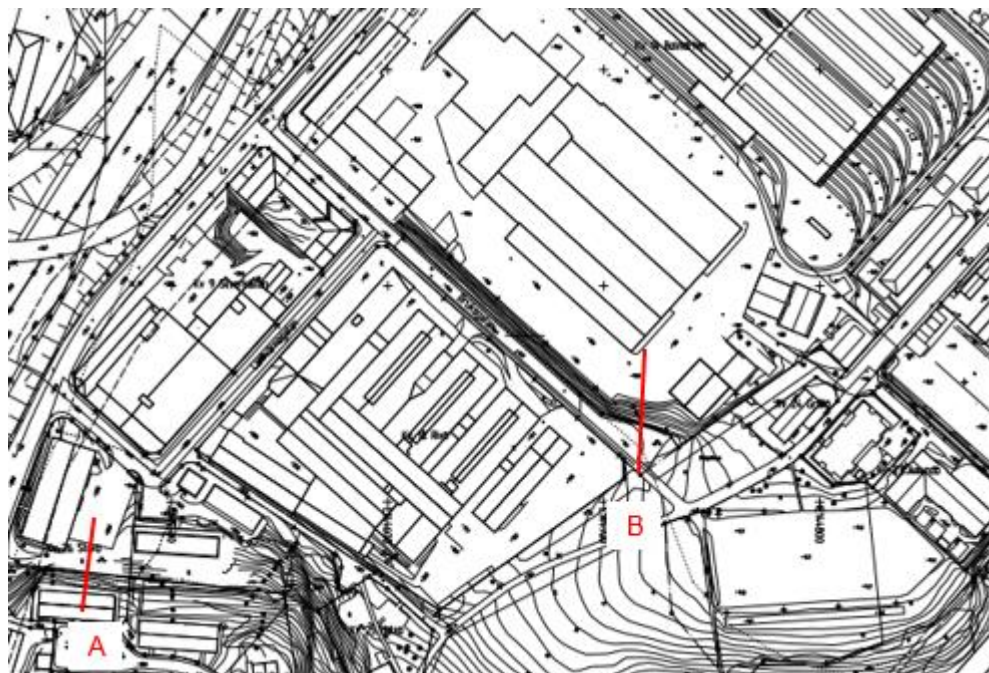
Figur 7 Läge för utförda stabilitetsberäkningar.
